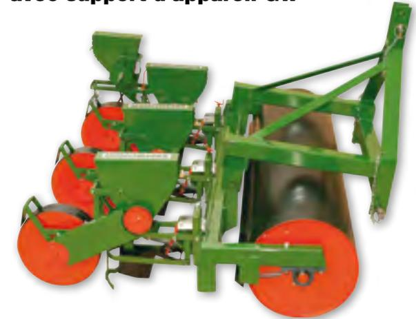
Le support avec cylindre d'entrée est indépendant du sillon du tracteur et est avant tout conseillé pour le pré-laminage simultané en cas de présence de sol meuble. On peut obtenir un enfouissement régulier grâce au rouleau-compresseur.
