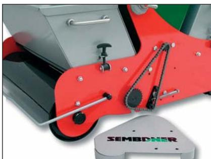
Der **Igelantrieb** erfolgt über eine Kette und wird durch eine Abdeckung geschützt.
