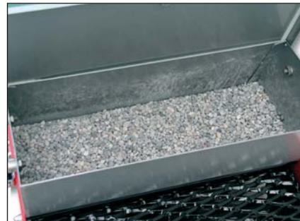
Über der Glattdruckwalze befindet sich ein abnehmbarer, robuster **Gewichtskasten**, der mit verschiedenen Mineralien gefüllt werden kann (Sand, Steine).
