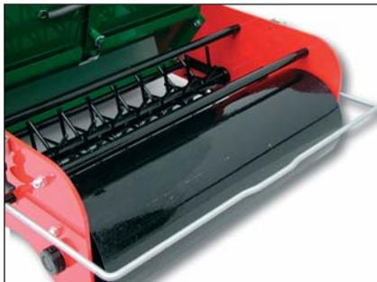
Der Igel wird durch Betätigen des **Bügels** in Transportstellung gebracht.
